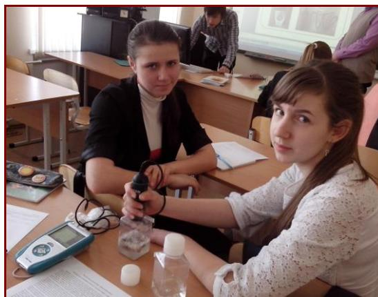
*Фото 4. Определение содержания кислорода в пробе с вареным мясом*
